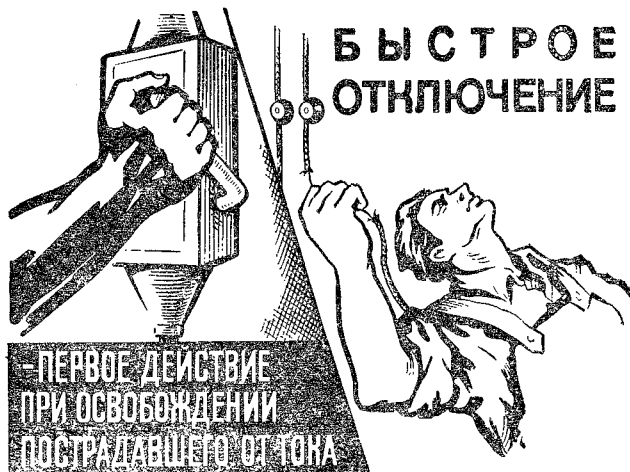
Рис. 1. Освобождение пострадавшего от действия тока путем отключения электроустановки
